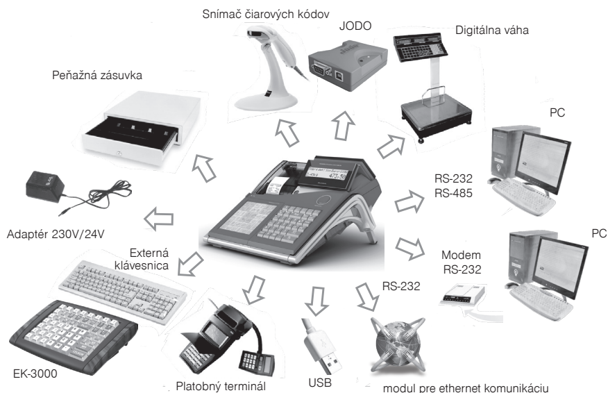
Obrázok 2.2 Externé zariadenia pripojiteľné k pokladniciam Euro-2100TE
